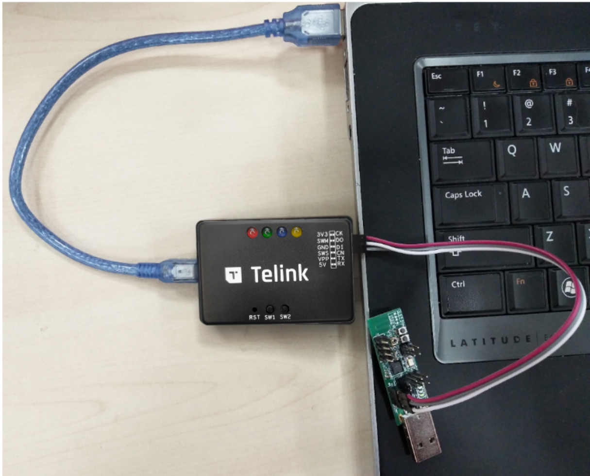
Figure 2.4: 通过 Swire 连接 “Burning EVK” 和目标板
