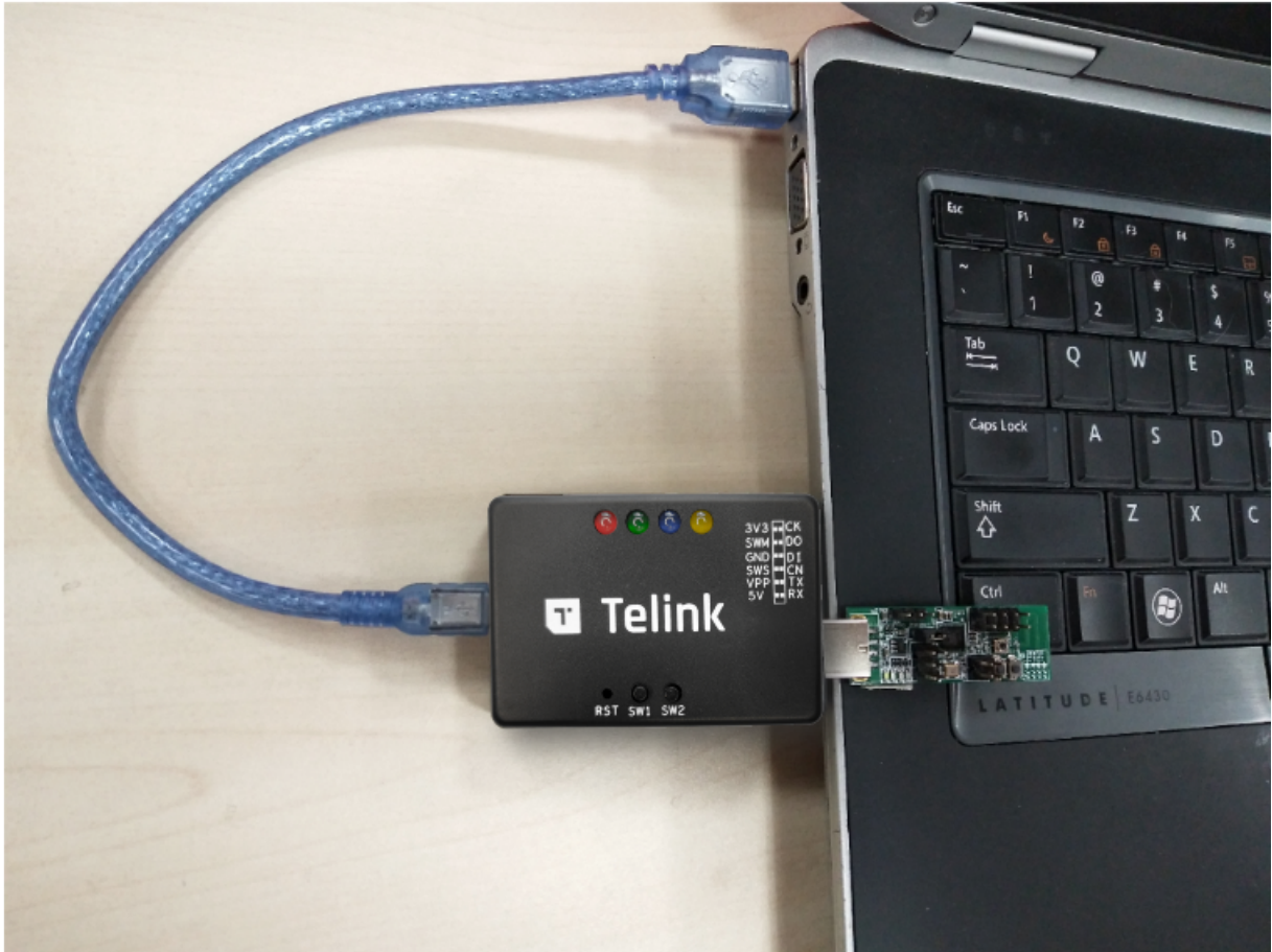
Figure 2.3: 通过 USB 连接 “Burning EVK” 和目标板
