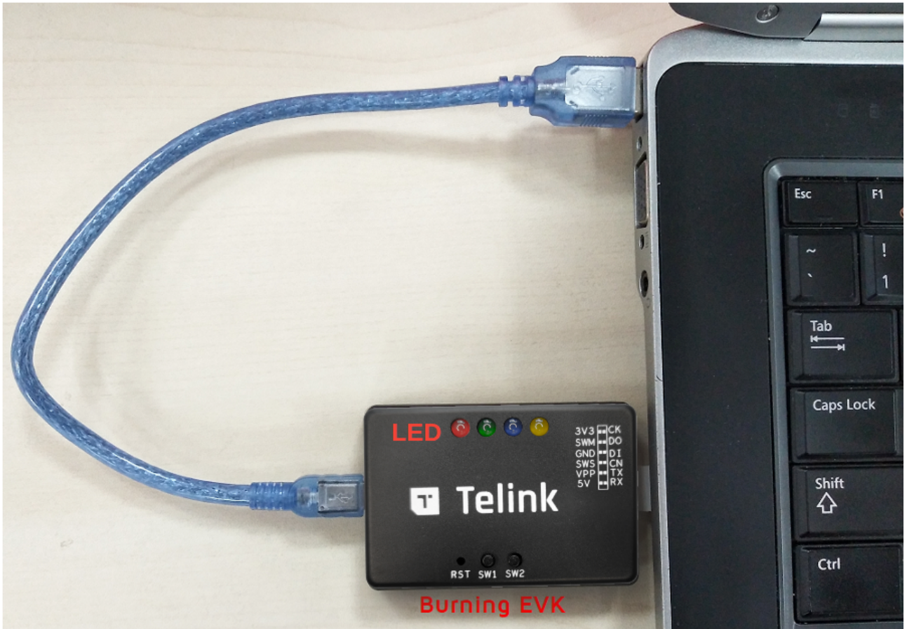
Figure 2.2: 将 “Burning EVK” 与 PC 连接
